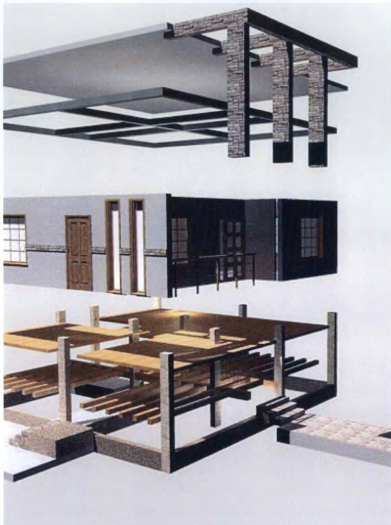
ESQUEMA SISTEMA CONSTRUCTIVO DE VIVIENDA
