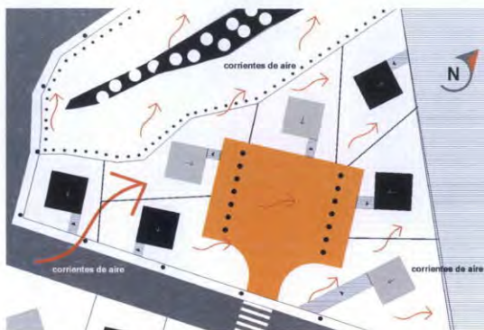
ESQUEMA CIRCULACIÓN DE AIRE PARA VENTILACIÓN
