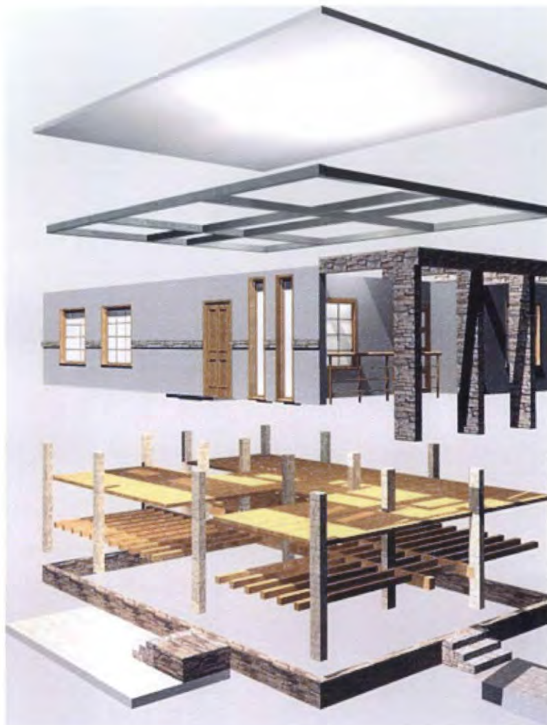
ESQUEMA SISTEMA CONSTRUCTIVO DE VIVIENDA
