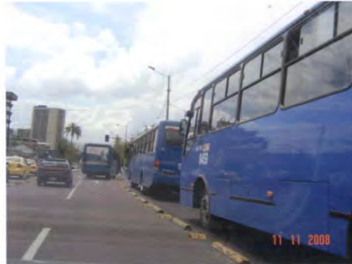
Sitios improvisados para estacionar las unidades en horas no pico, con lo cual estas unidades producen riesgos de accidente al resto de vehículos debido que ocupan los carriles de circulación vehicular para hacer de estos estacionamientos.
