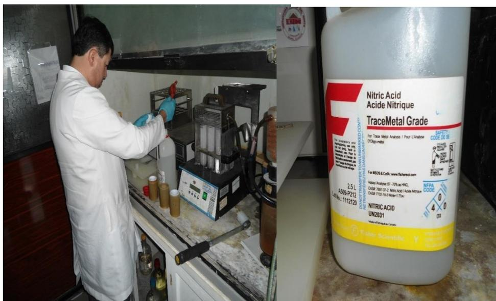
Figura 20. Aplicación de reactivos para la digestión ácida.
