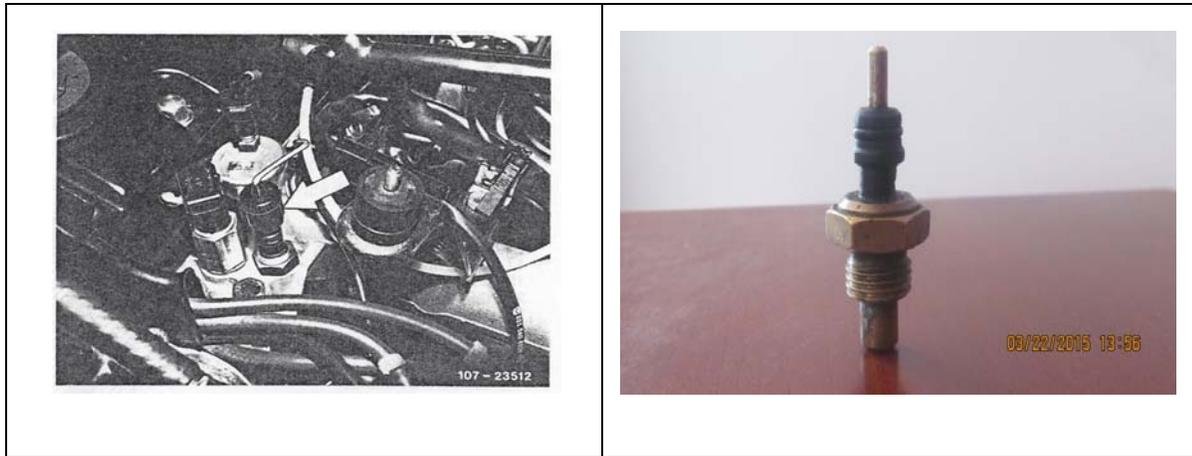
Figura 7 Sonda térmica o trompo de temperatura de refrigerante.
