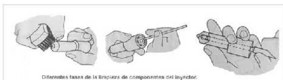
Figura 16. Fases de la limpieza de componentes del inyector. (www.maquinac.com, 2014)
