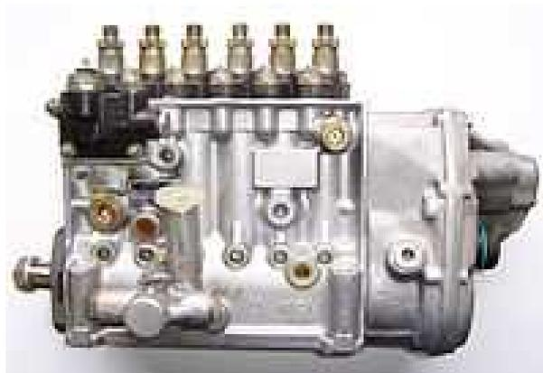
Figura 8. Bomba de inyección. (GIACOSA, 2005)
