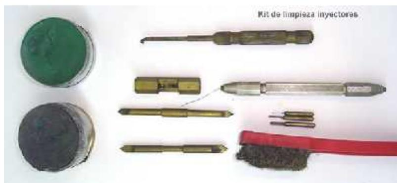
Figura 17. Materiales de limpieza para los componentes del inyector. (www.maquinac.com, 2014)
