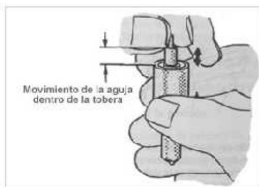
Figura 18. Colocación de la tobera en posición vertical. (www.maquinac.com, 2014)
