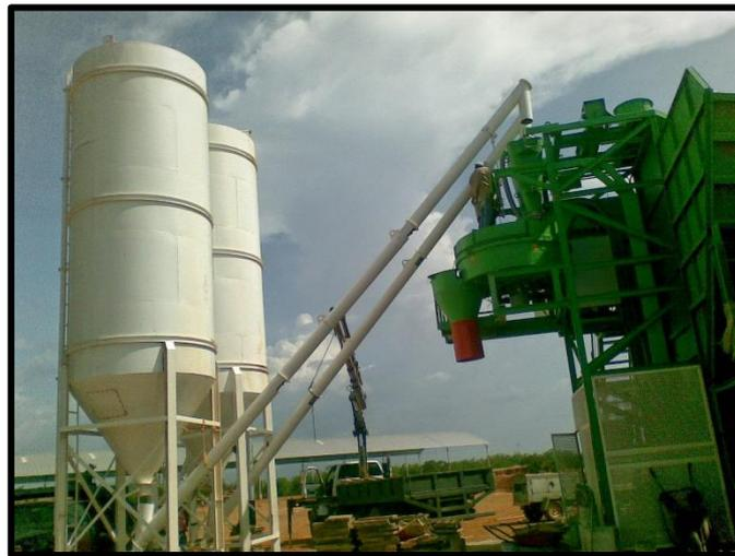
**Imagen No. 10 Silos de cemento.**
