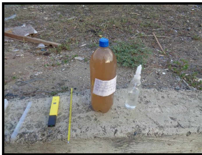
FIGURA 15. Termómetro, pH-metro, muestra, agua destilada
