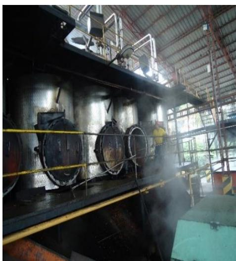
**Figura 7. Autoclaves verticales utilizadas en la esterilización de los racimos de fruta fresca de palma.**
