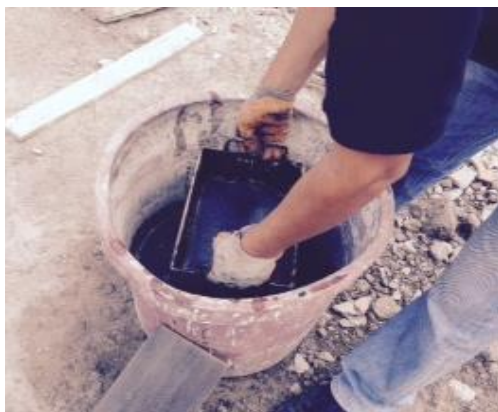
Ilustración # 25 Enfriamiento en un cuerpo de agua
