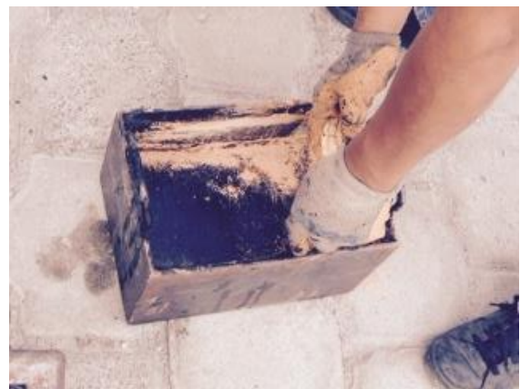
Ilustración # 24 Separación de los costados con la ayuda de material arcilloso (Caolín)
