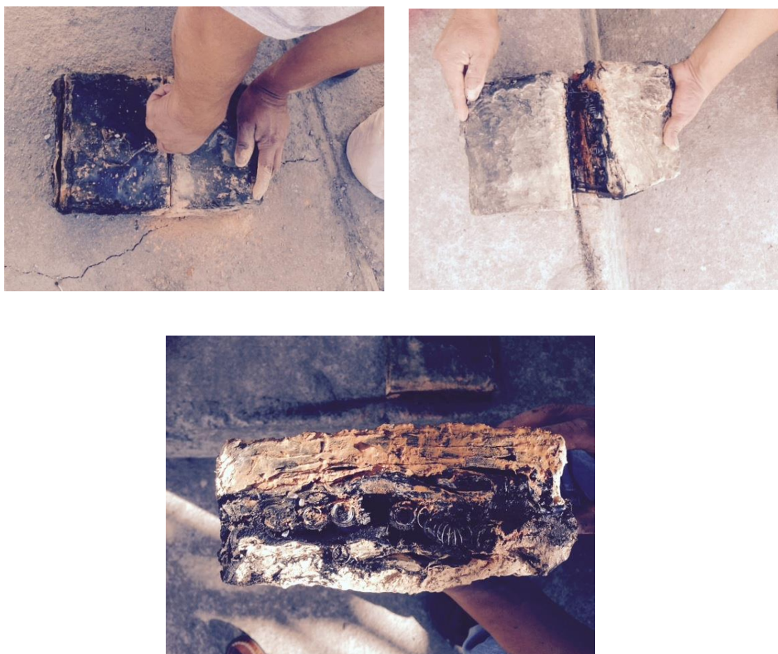
Ilustración # 28 CORTE TRANSVERSAL DE JERINGAS
