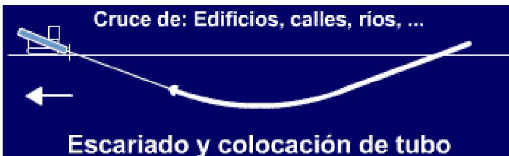
**Ilustración 3 INSTALACIÓN DE TUBERÍA**
