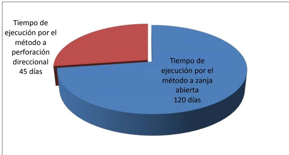
**Ilustración 14 TIEMPOS DE EJECUCIÓN DEL SOTERRAMIENTO**
