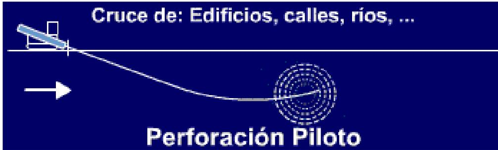
**Ilustración 2 PERFORACIÓN GUÍA O PILOTO**
