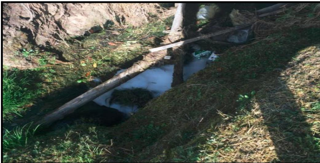
Imagen 1. Presencia de espuma en canal de descarga al río Granobles
