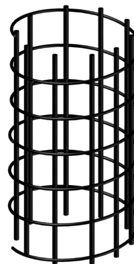
Imagen 91. Detalle de refuerzo helicoidal rodeando varillas verticales.
