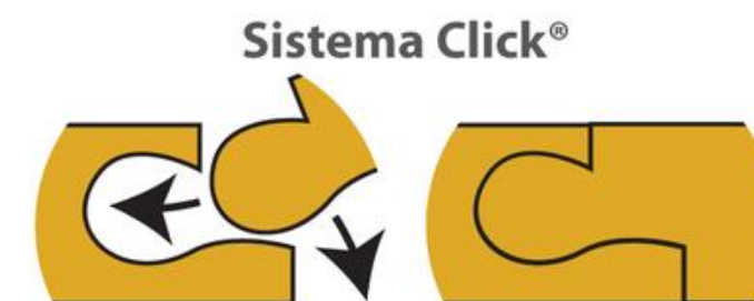
Imagen 114. Sistema Click para instalación de pisos flotante
