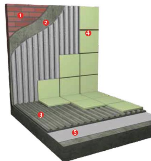
Imagen 119. Proceso de instalación de porcelanato
