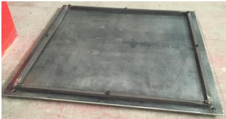
Figura 24. “Caja desarmable para producir planchas”.
