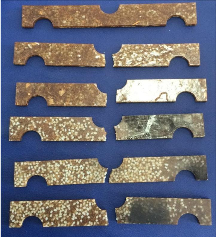
Figura 45. “Probetas de Flexión después de los Ensayos”.
