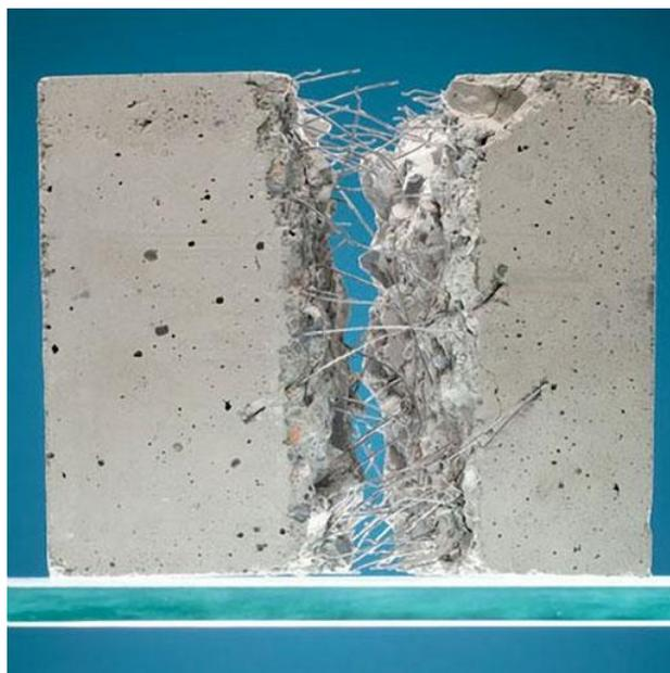
*Figura 1.* Hormigón Reforzado con Fibras de Acero. Fuente: Soluciones Especiales, noviembre del 2013.
