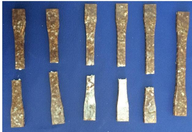
*Figura 41.* “Probetas de Tracción después de los Ensayos”.
