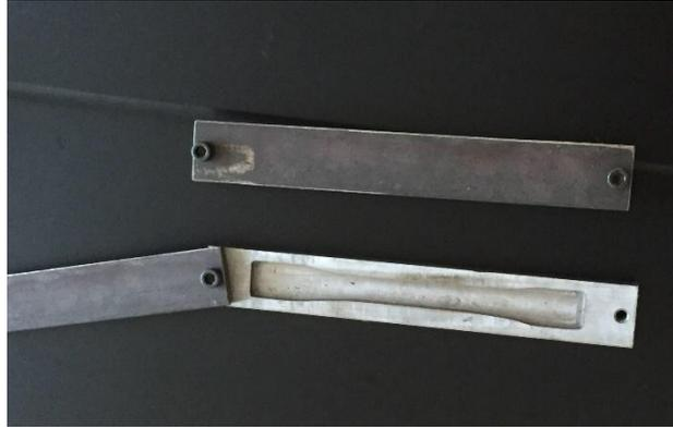
*Figura 22.* “Moldes Probeta de Tracción”.
