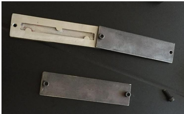
*Figura 23.* “Molde Probeta de Flexión”.
