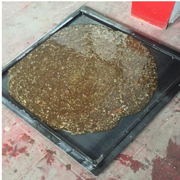
*Figura 32.* “Mezcla vertida en el molde”.
