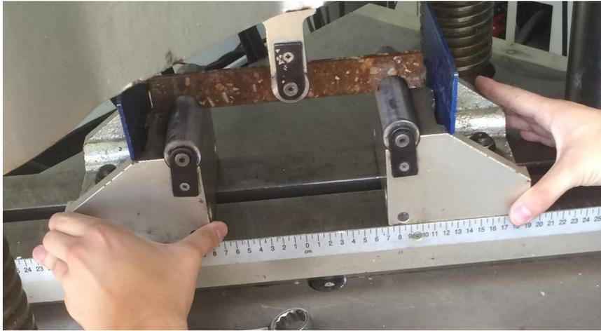
*Figura 42. “Colocación de Probeta de Flexión”*
