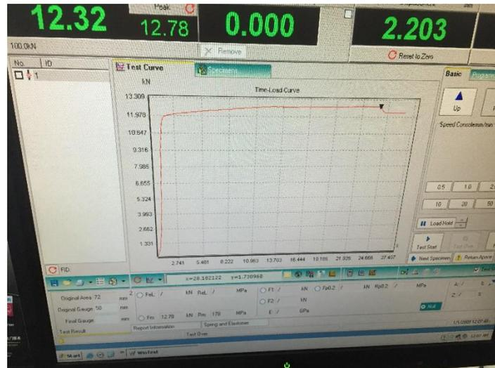
Figura 38. “Curva Fuerza vs Tiempo – Ensayo de Tracción”
