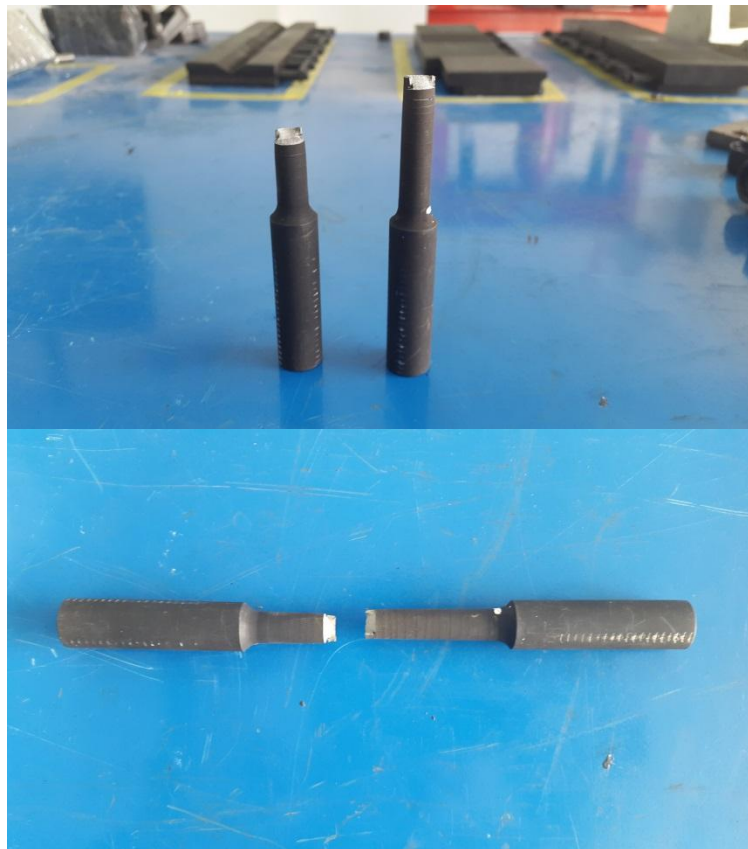
Figura 19. Probeta de acero con tratamiento térmico de nitruración posterior a la prueba de tensión.
