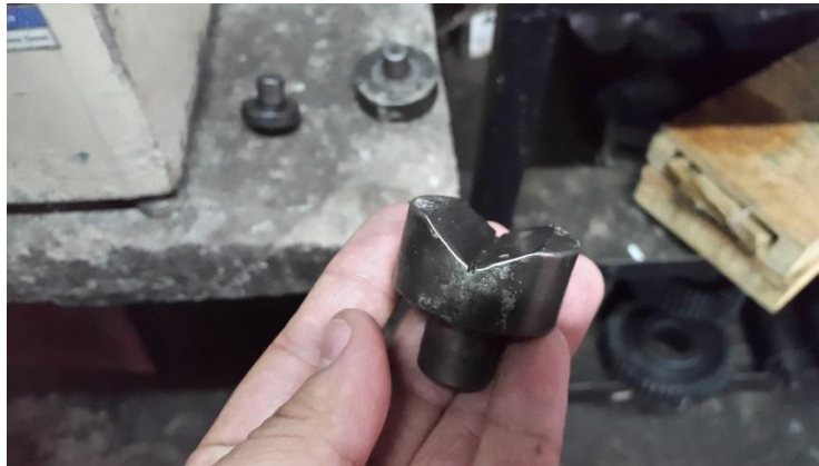
Figura 7. Base para la medición de dureza en secciones circulares
