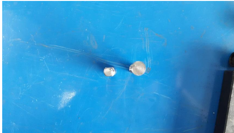
Figura 36. Probeta de acero sin tratamiento térmico posterior a la prueba de torsión.
