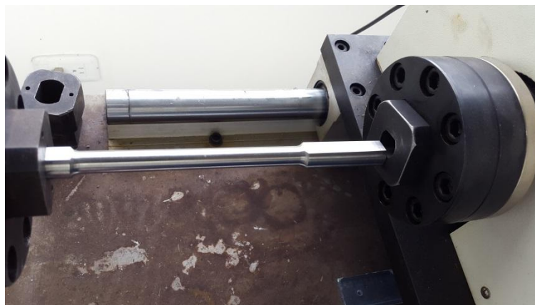
Figura 15. Probeta lista para ubicarse en la máquina de torsión
