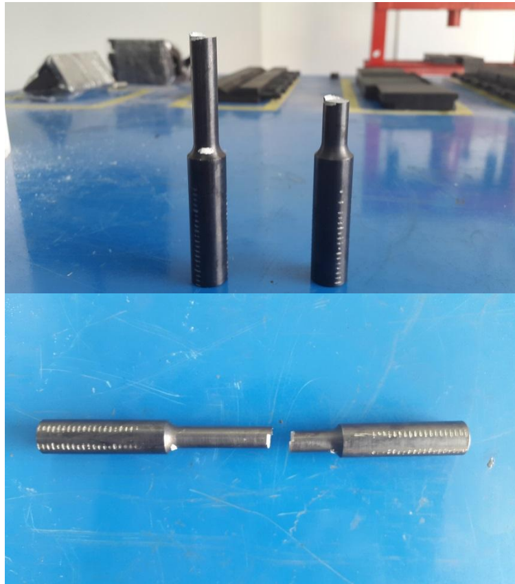
Figura 17. Probeta de acero con tratamiento térmico de temple subcero posterior a la prueba de tensión.
