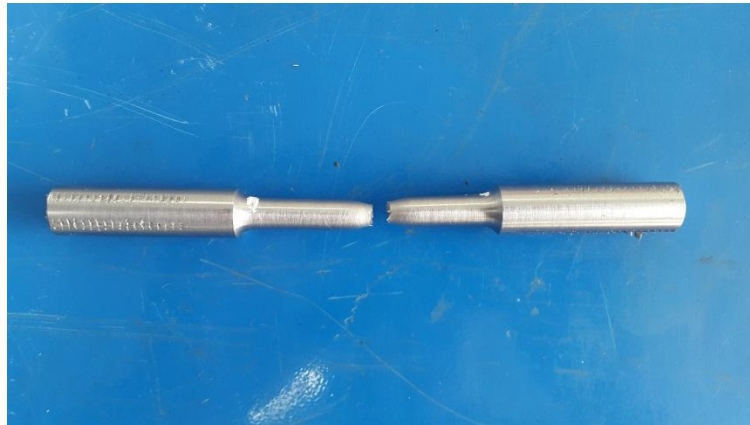
Figura 21. Probeta de acero sin tratamiento térmico posterior a la prueba de tensión.
