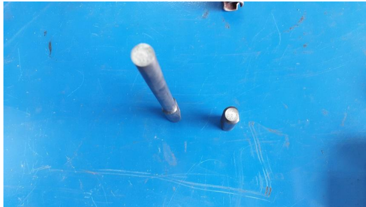
Figura 26. Probeta de acero con tratamiento térmico de temple subcero posterior a la prueba de torsión.
