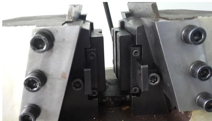
Figura 11. Mordazas para ensayo de tracción de probetas circulares.
