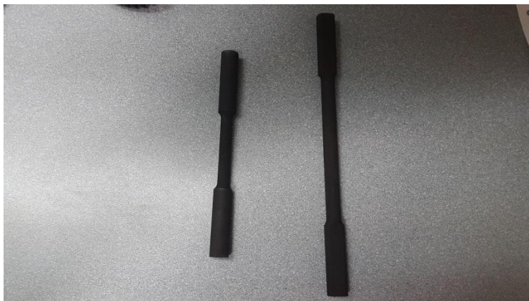
Figura 5. Probetas después de tratamiento térmico
