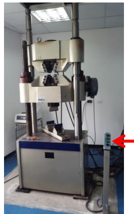
Figura 13. Máquina de ensayos universales y controlador de mordazas.
