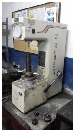
Figura 6. Máquina para medición de dureza
