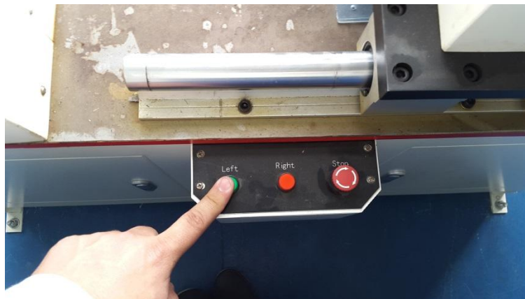
Figura 14. Pulsadores de máquina de torsión
