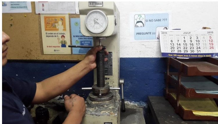
Figura 10. Medición de la dureza de la probeta de torsión
