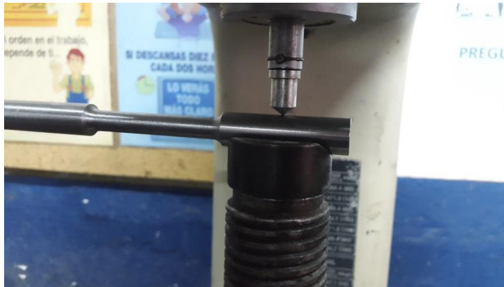
Figura 8. Medición de la dureza de la probeta de tracción.
