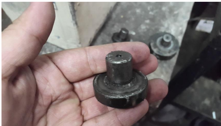
Figura 9. Base para la medición de dureza en secciones planas
