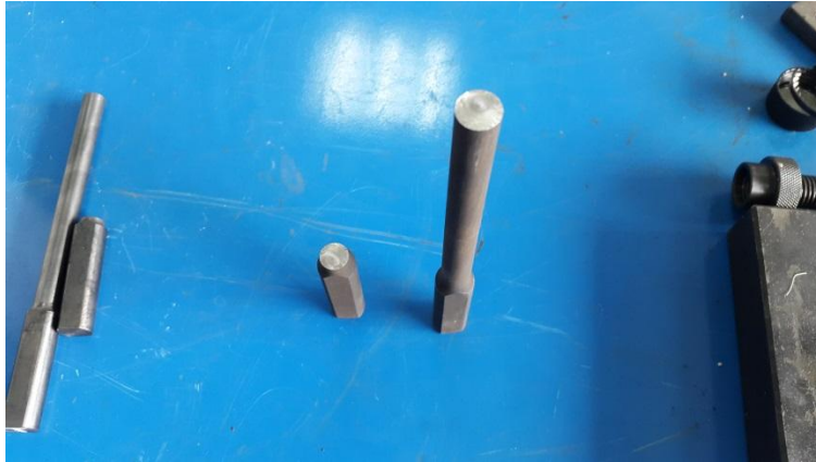
Figura 31. Probeta de acero con tratamiento térmico de nitruración posterior a la prueba de torsión.
