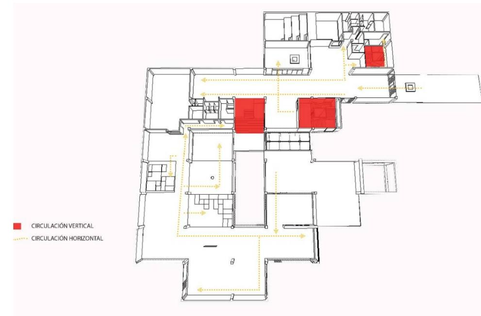
Figura 78: Esquema de circulación - 9.00
