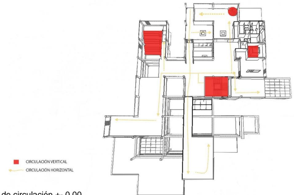
**Figura 72:** Esquema de circulación +- 0.00
