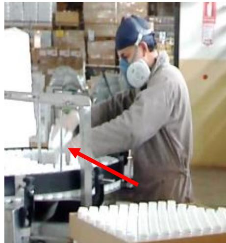
Fig 44. Acción técnica colocar, mano izquierda, alimentador de envases
