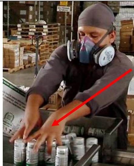
Fig 80. Acción técnica alcanzar, mano izquierda encartonador
