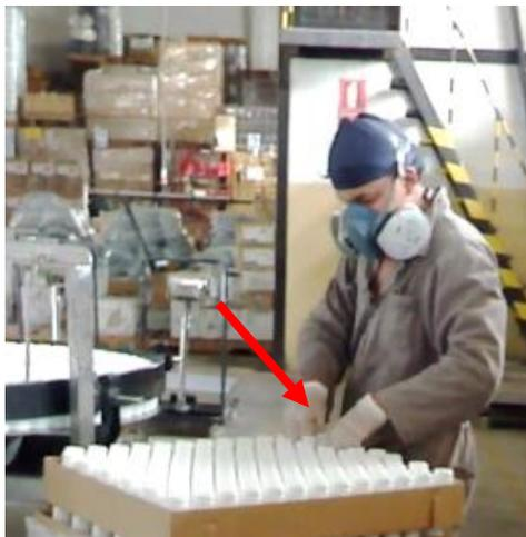
Fig 41. Acción técnica coger con mano derecha, alimentador de envases
