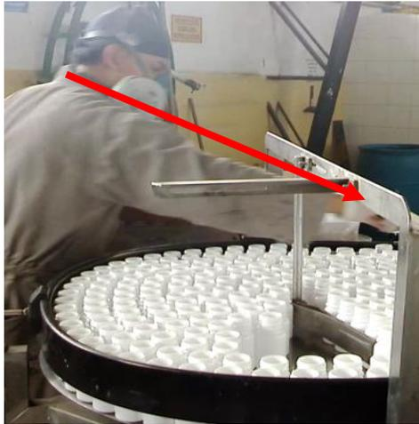
Fig 39. Acción técnica alcanzar mano derecha, alimentador de envases
