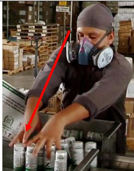
Fig 79. Acción técnica alcanzar, mano derecha encartonador
