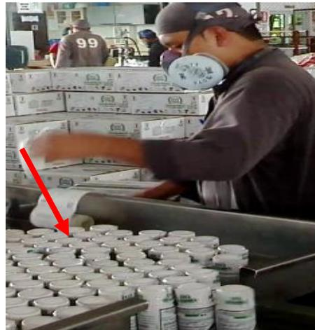
Fig 84. Acción técnica Coger con la izquierda y pasar a la derecha , mano izquierda encartonador
