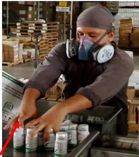
Fig 95. Acción técnica coger, mano derecha encartonador
