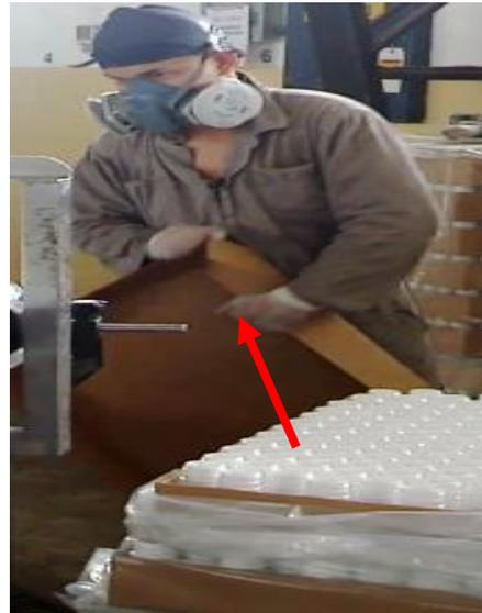
Fig 46. Acción técnica tirar, mano izquierda, alimentador de envases
