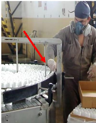
Fig 47. Acción técnica tirar, mano derecha alimentador de envases
