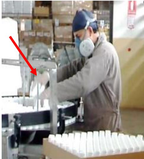
Fig 45. Acción técnica colocar, mano derecha, alimentador de envases
