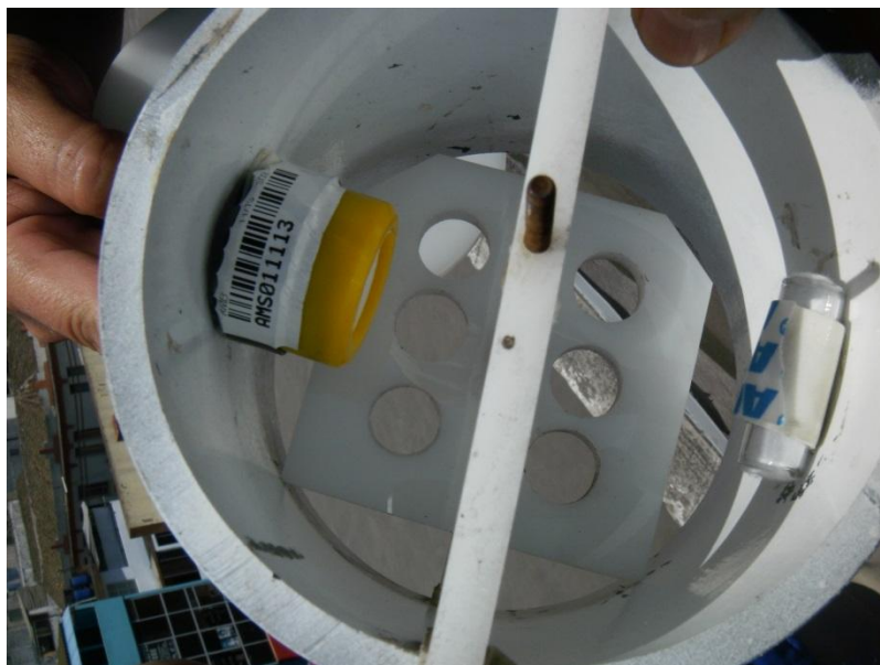
Fotografía 5. Colocación de monitores de BTX y \text{SO}_2
