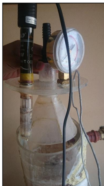
Gráfico N°. 11: Campana GSL del reactor UASB SE-K01 Elaborado: Erazo & Salvador, 2014
