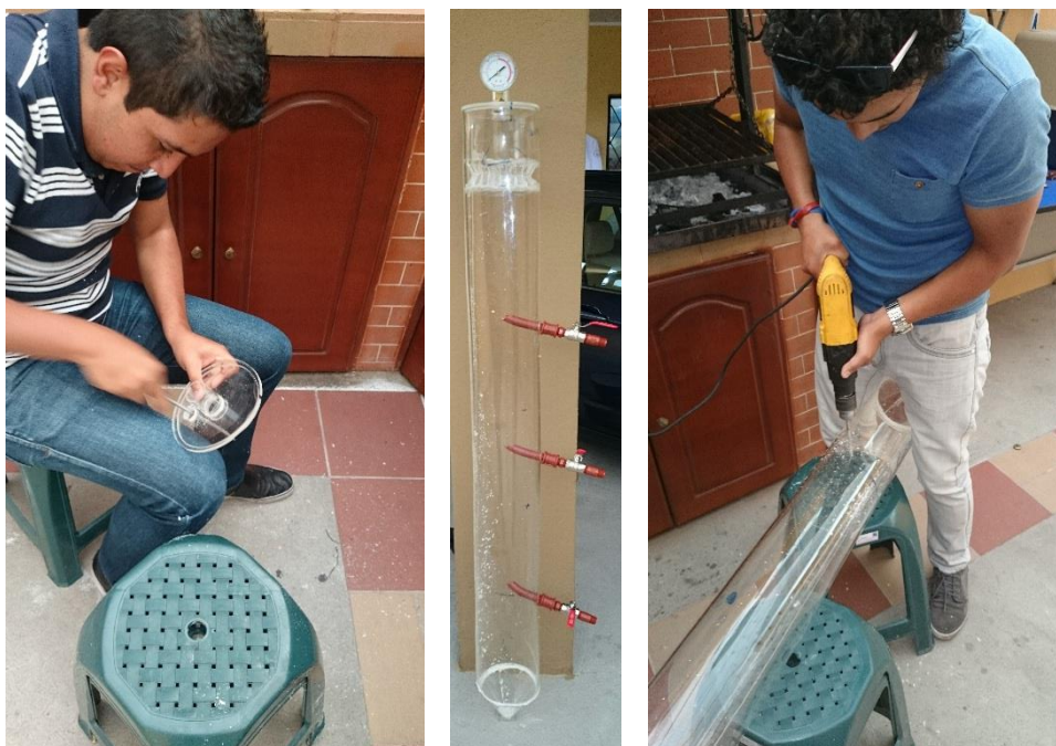
Imagen N°. 1: Fabricación de Puntos de Muestreo Elaborado: Erazo & Salvador, 2014
