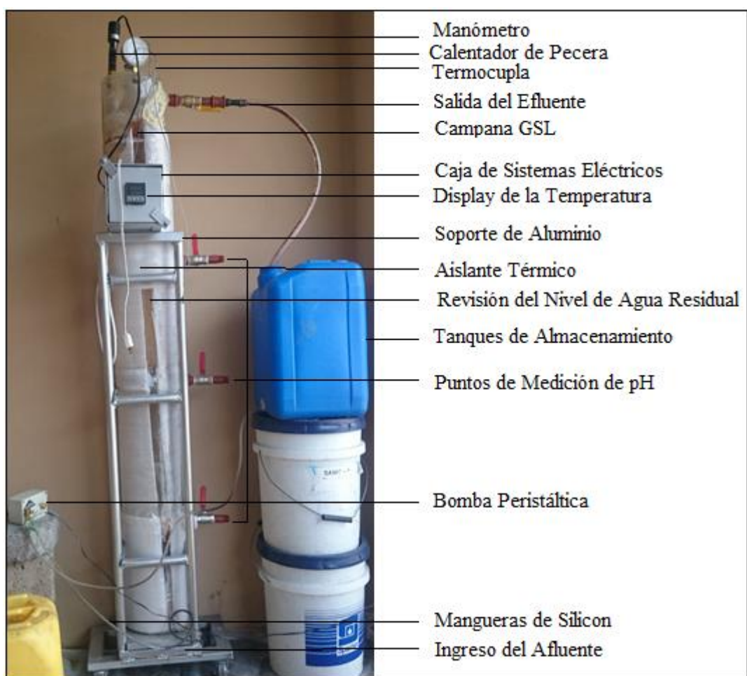
Gráfico N°. 10: Partes del Reactor UASB SE-K01 Elaborado: Erazo & Salvador, 2014
