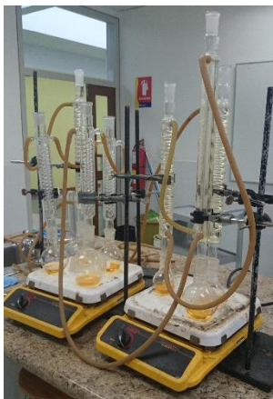
Imagen N° 2: Equipo de DQO para Reflujo Abierto Elaborado: Erazo & Salvador, 2014
