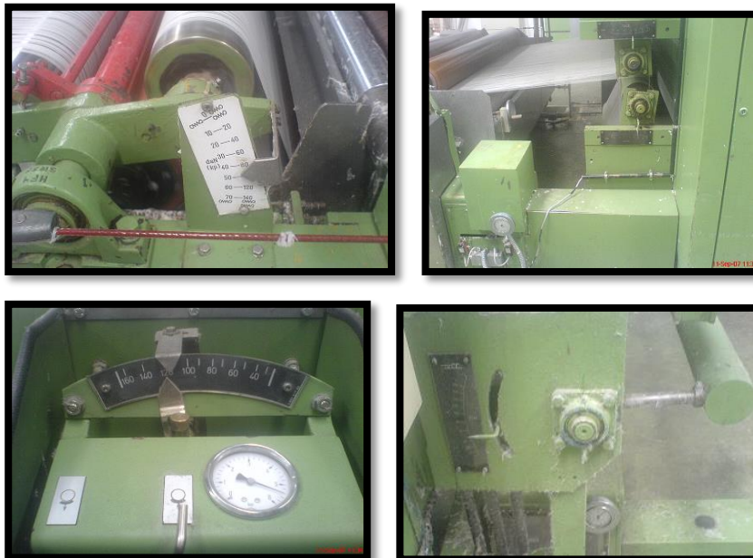
Figura 14. Medidores de Controles de Presión y Tensiones
