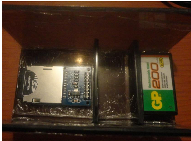
Figura 10. Ubicación del módulo SD y batería de alimentación.
