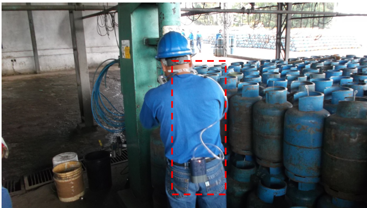
Figura N °14: Equipo en funcionamiento para el muestreo del ambiente laboral
