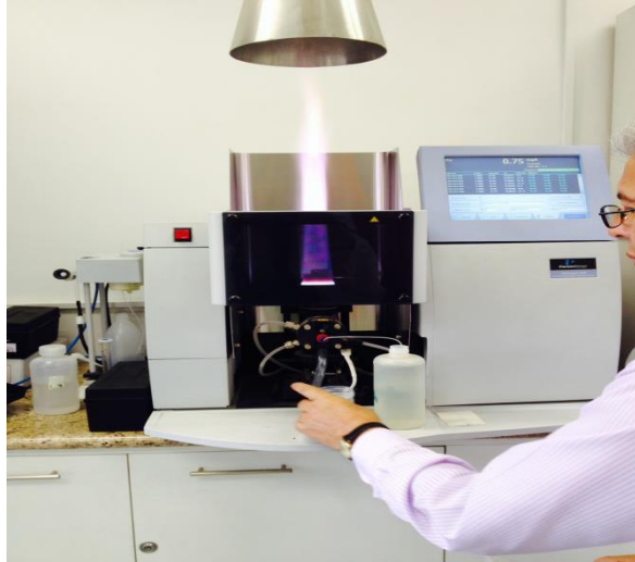
Fotografía #2 tomada por Angélica Cruz (2014) Espectrofotómetro de Absorción Atómica de llama (EAA)
