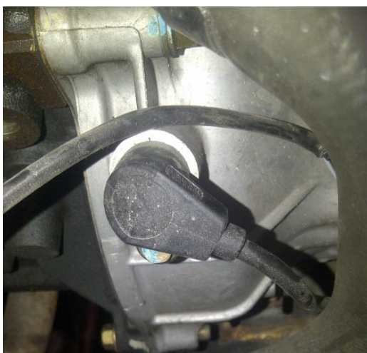
Figura 29: Ubicación del sensor CKP del vehículo Chevrolet Spark, Xavier Romero (2013)
