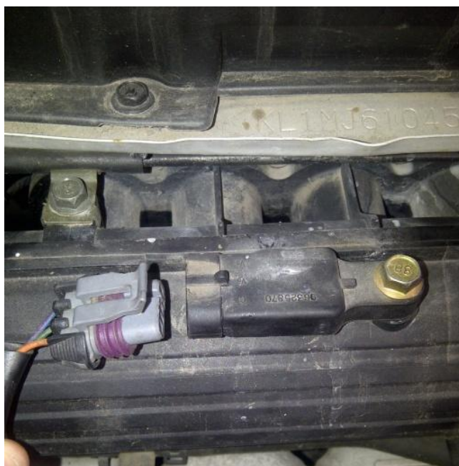
Figura 21: Ubicación sensor MAP del vehículo Chevrolet Spark, Xavier Romero (2013)
