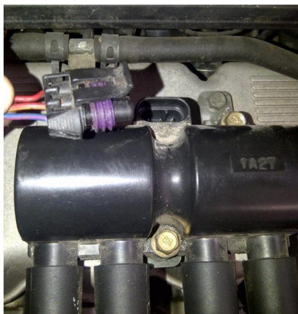
Figura 34: Ubicación de la bobina del vehículo Chevrolet Spark, Xavier Romero (2013)
