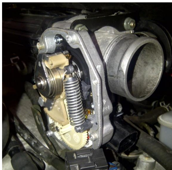
Figura 23: Ubicación sensor TPS del vehículo Chevrolet Spark, Xavier Romero (2013)
