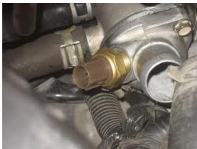
Figura 25 : Ubicación del sensor ECT del vehículo Chevrolet Spark, Xavier Romero (2013)
