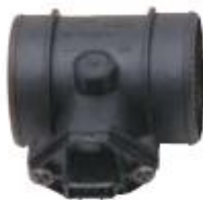
Figura 9: Medidor de flujo de aire sistema Bosch, Recuperado de Sistemas de Inyección Electrónica, Manual Bosch, pág. 15
