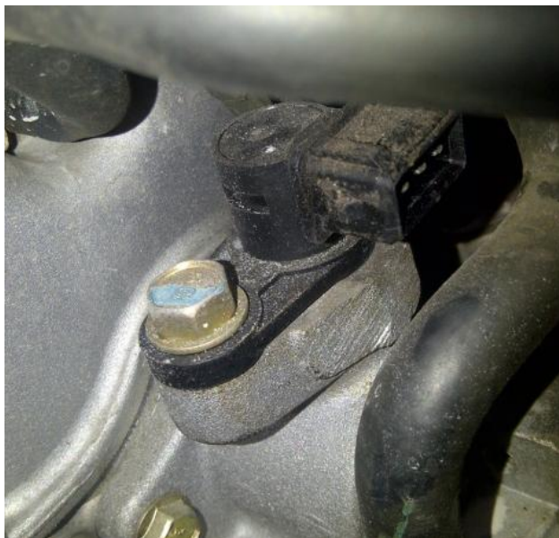
Figura 31: Ubicación del sensor CMP del vehículo Chevrolet Spark, Xavier Romero (2013)
