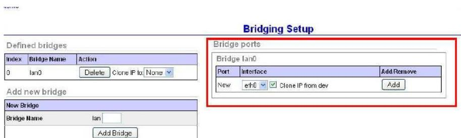
Figura: Sección "Bridging Setup". Añadir interfaz eth0
