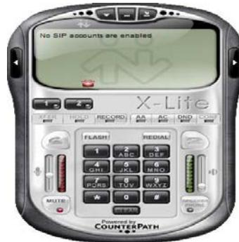
Para configurar una extensión se debe dar click derecho sobre cualquier parte de la ventana y seleccionar Sip Account Settings. Este le muestra la lista de las cuentas SIP instaladas. Como aún no se ha instalado ninguna, aparece vacía. Para agregar una cuenta seleccione Add.
