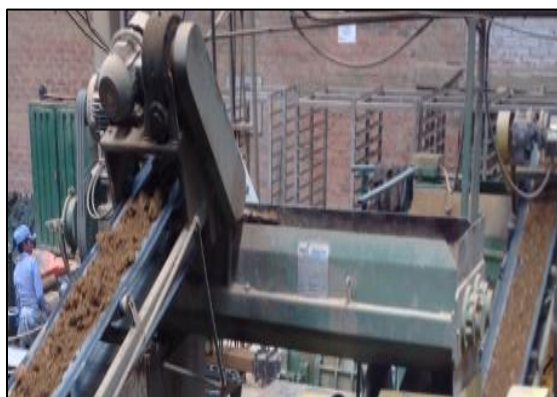
Figura 21: Mezclador doble tornillos sin fin. (Autor).
