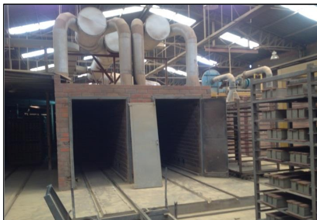
Figura 26: Secador Túnel. (Autor).
