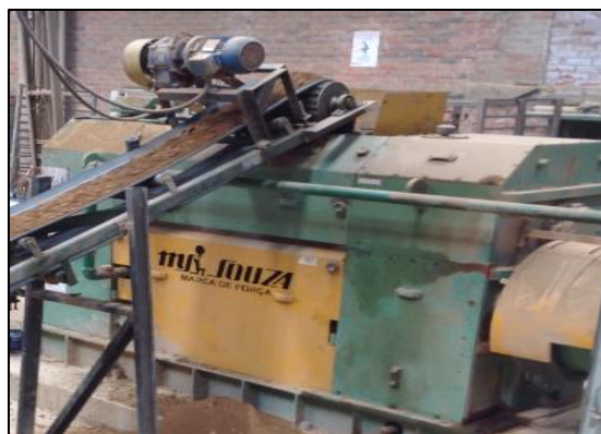
Figura 23: Extrusora al vacío. (Autor).
