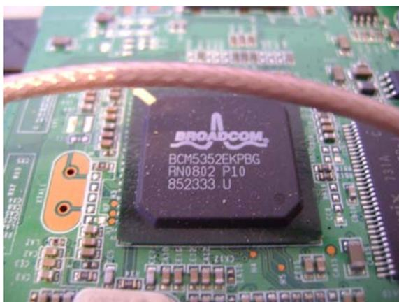
Ilustración 3-4 Procesador BCM5352 de un WRT54GL
