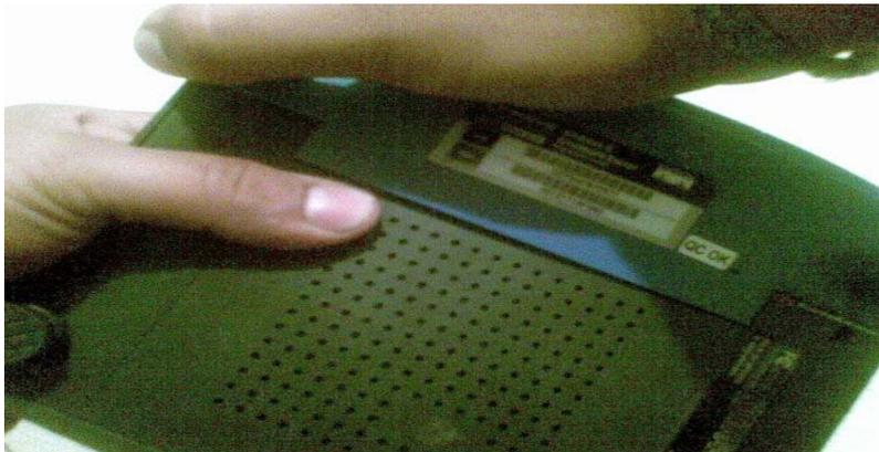
Ilustración 5-6 Manera en la que se destapa un enrutador inalámbrico WRT54G
