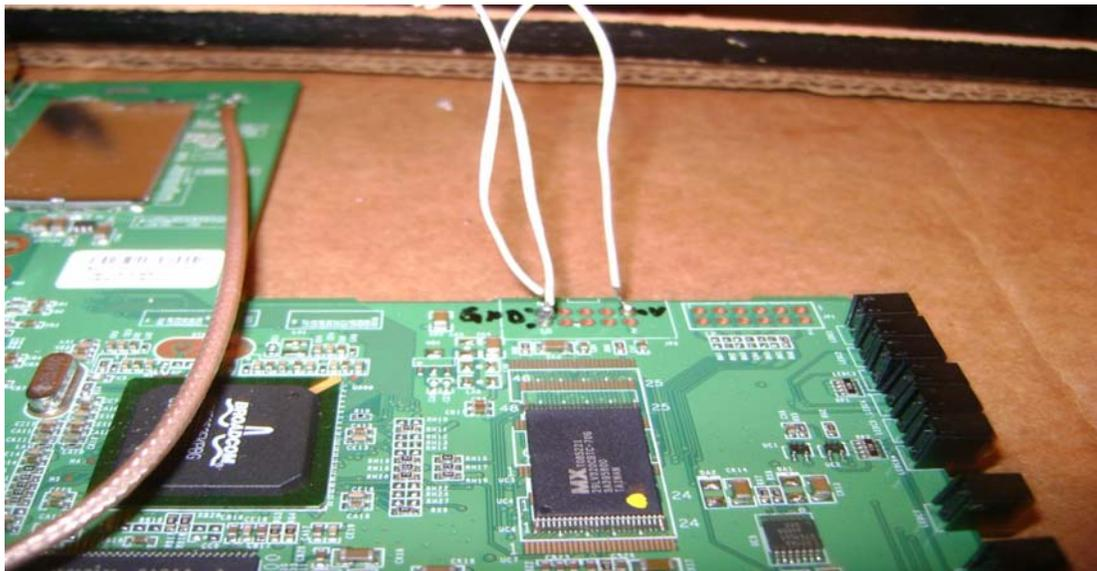
Ilustración 5-38 Puertos GND y de Voltaje soldados al dispositivo.
