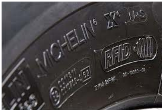
Gráfico 9. Ejemplo de un neumático que viene con un tag RFID de fábrica
