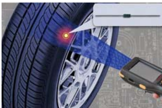
Gráfico 10. Ejemplo de la captura de información de un tag RFID por medio de un lector RFID
