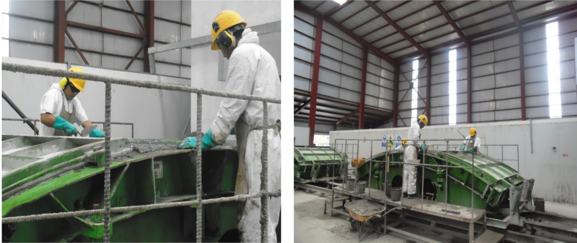
Grafico 26: Alisador de hormigón sobre molde
