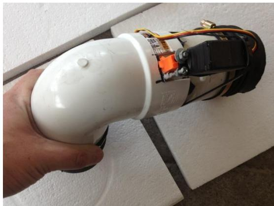
*Figura 15.* Sujeción del servomotor al cilindro PVC por medio de pernos de 30mm.
