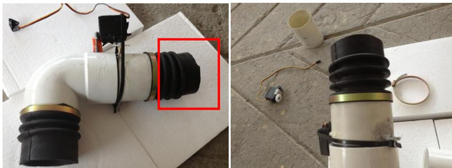
*Figura 16.* Instalación de manguera flexible en el extremo de la mariposa SCVM hacia el filtro de aire del vehículo.
