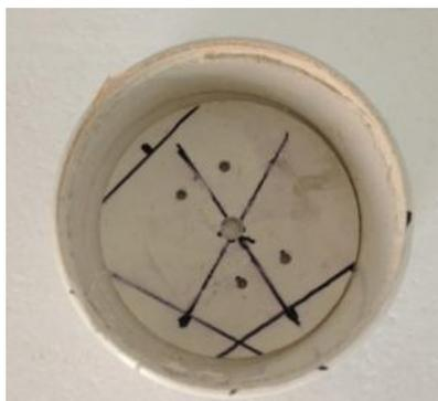
*Figura 12.* Tapon PVC recortado para formar un disco circular.
