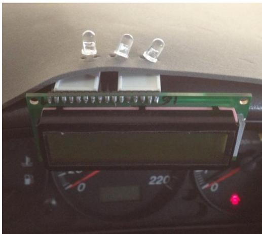
*Figura 3.* Alertas luminosas a la altura del piloto, ubicadas para no encandilar los ojos del conductor.
