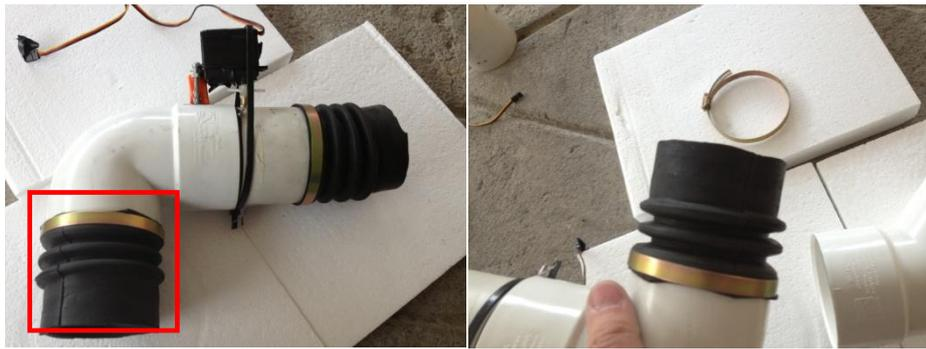
*Figura 17.* Instalación de manguera flexible en el extremo de la mariposa SCVM hacia la mariposa de admisión original del vehículo.
