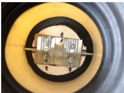
*Figura 14.* Aleta de admisión sujeta al eje por pernos y láminas de latón
