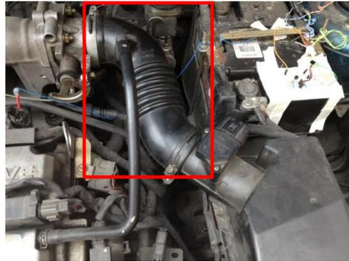
*Figura 9.* Conducto de admisión de aire original del vehículo.
