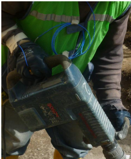
Fig. 3.11. Agarre correcto del martillo con sensor instalado
