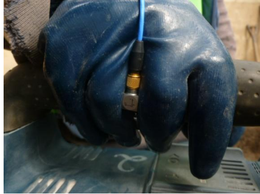
Fig. 3.15. Ubicación del acelerómetro "dado" respecto a los ejes.
