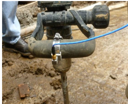
Fig. 3.14. Orientación de la abrazadera soporte del dado para comodidad del Operador
