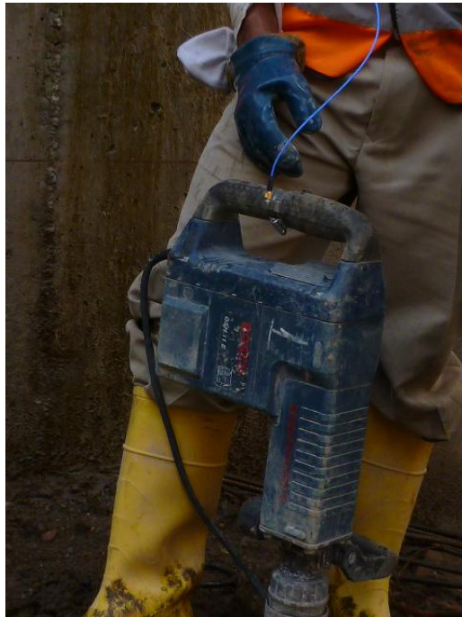
Fig. 3.8. Fijación del acelerómetro en equipo usado
