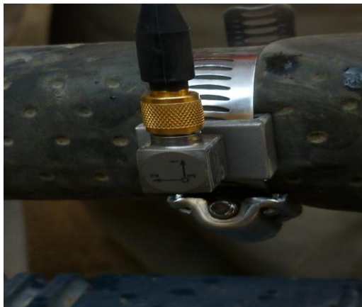
Fig. 3.9. Orientación del acelerómetro triaxial
