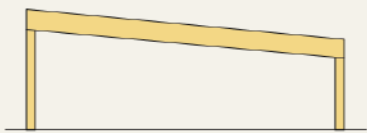
Vigas rectas sobre pilares de 10 a 30 m.
