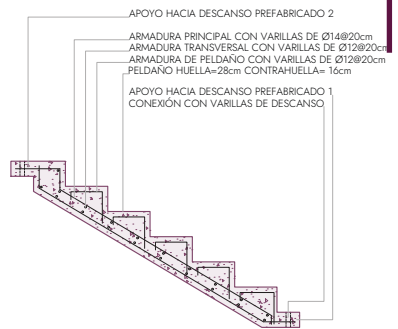
86 SECCIÓN LONGITUDINAL GRADA PREFABRICADA 2 E11 ESC. 1:25
