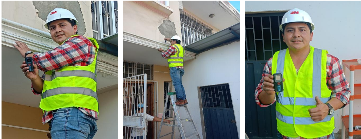
Figura 15 Toma de datos del espesor de las losas
