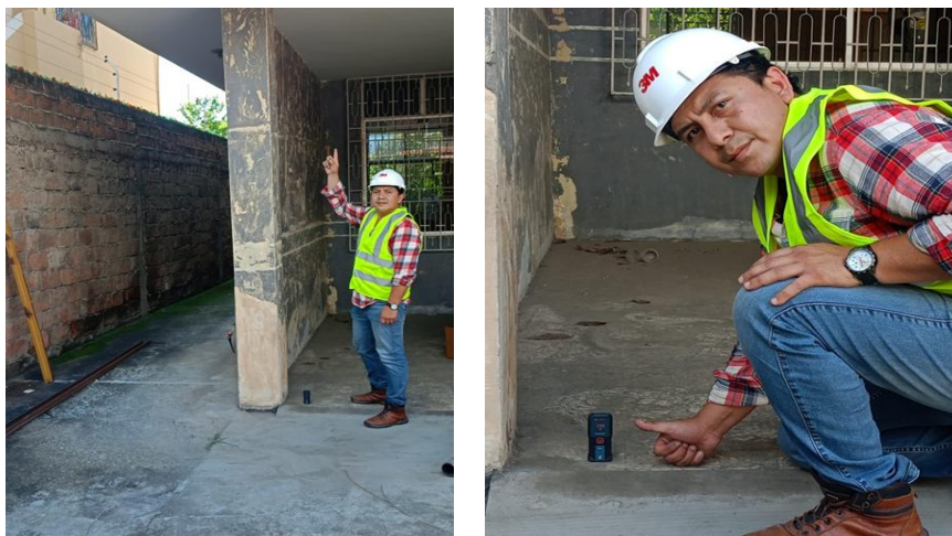
Figura 14 Toma de datos de la altura de columnas
