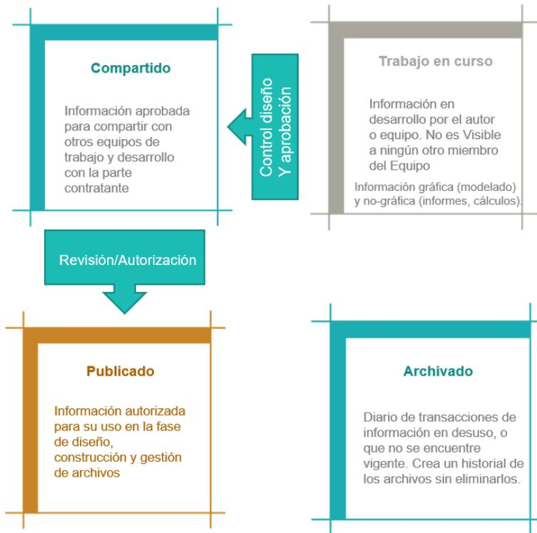
**Nota.** La Ilustración 29 **Ilustración 8** muestra el flujo del entorno común de datos;
