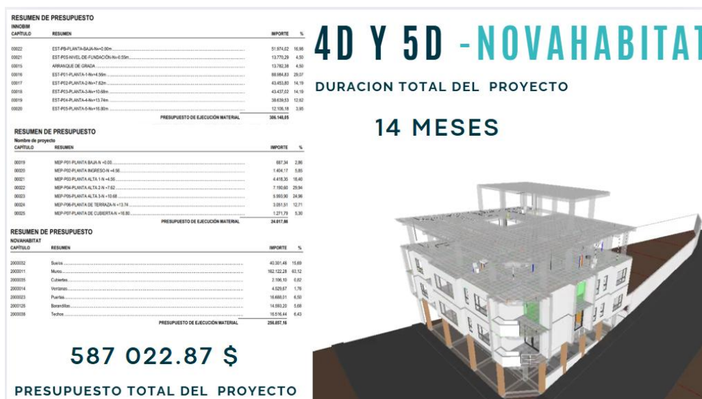
Ilustración 8 Programación 4D y 5D vinculadas al modelo federado
