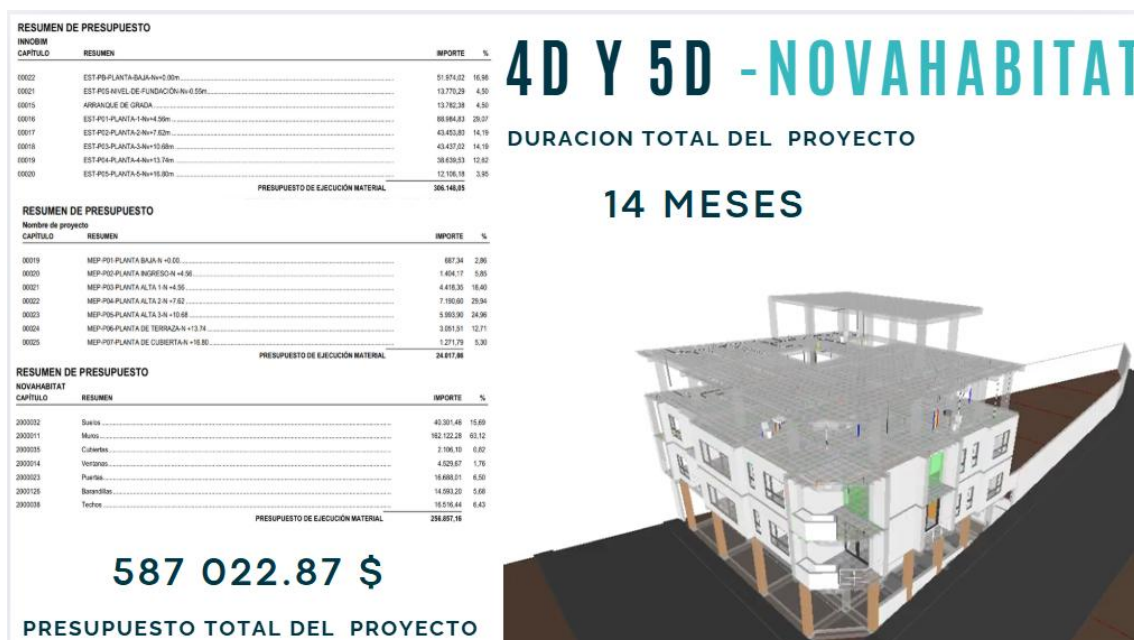
Ilustración 12: Programación 4D y 5D vinculadas al modelo federado.
