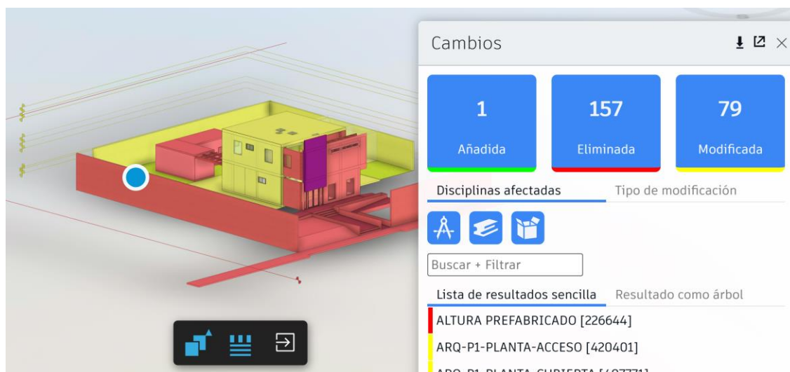
Ilustración 14 Captura de pantalla del ACC de Autodesk comparando la versión antes y después de la ampliación solicitada por el cliente. Autor BIMSS
