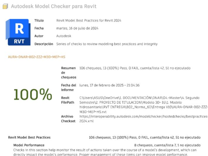
Figura 23 Informe de verificación de modelo MEP-HS B01. Fuente: Autor
