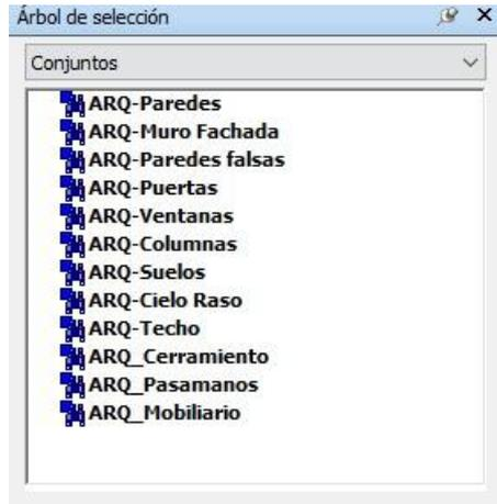
Ilustración 47 Conjuntos elaborados para la auditoría de los modelos. Software: Navisworks
