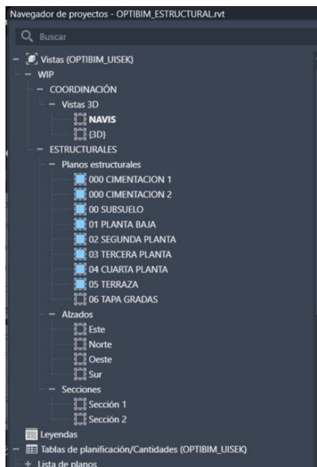
Figura 43 Estructura del navegador de la plantilla estructural
