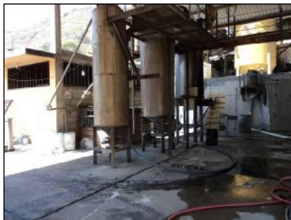
Fotografía No 11 Torres de Carbón junto al Caldero
