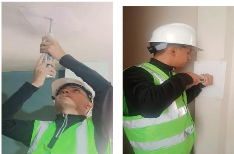
*Figura 16. Ensayo de los elementos con el esclerómetro.*
