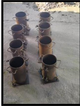
*Probetas de cilindros para incorporar el hormigón*
