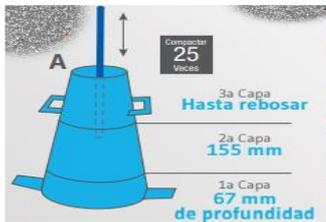
Asegúrese de homogenizar la mezcla antes de iniciar con el ensayo. Humedezca las herramientas a utilizar mencionadas anteriormente. Llene el cono en tres capas de igual volumen, la primera capa a una profundidad de 67 mm, la segunda capa de 155 mm y la tercera hasta rebosar el cono. Cada capa se deben realizar 25 apisonamientos con la varilla lisa inclinándola ligeramente en las primeras capas distribuyendo uniformemente los apisonamientos.
