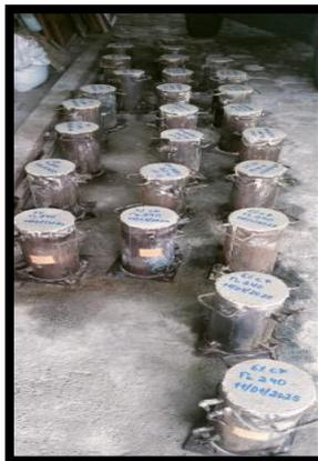
Colocación de las etiquetas en los cilindros
