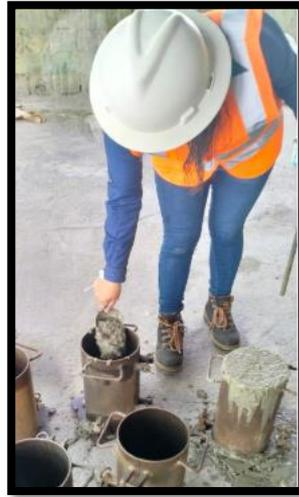
Colocación del hormigón en los cilindros
