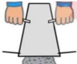
Colocando las manos con firmeza sobre los mangos del cono y aplicando un poco de fuerza hacia abajo mientras retira los pies de la parte inferior del cono, después levante el cono con un solo movimiento ascendente en un tiempo de 5 +/- 2 segundos, sin producir movimientos laterales o de torsión al concreto.
