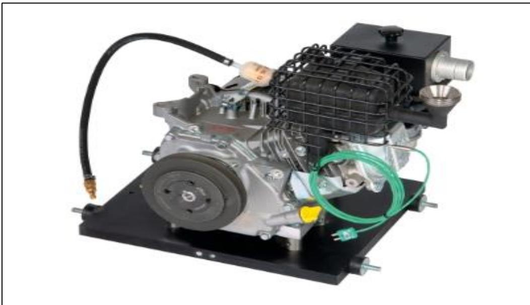
*Nota.* Motor de Gasolina de un cilindro 4 tiempos refrigerado por aire.
