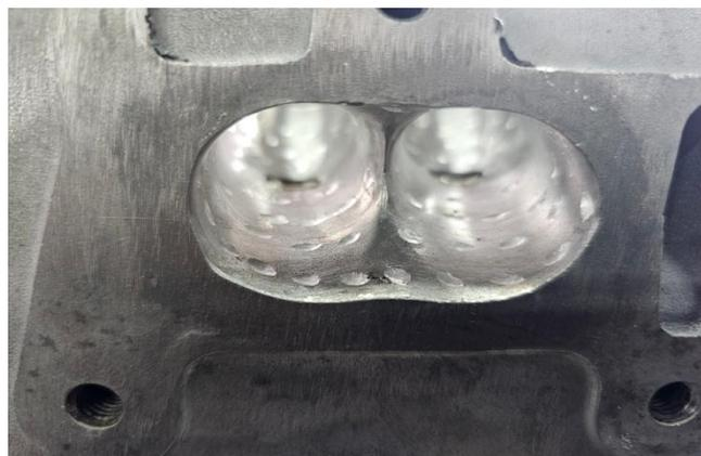
En la cámara de admisión (Figura 25), es necesario contar con perforaciones internas que generen turbulencias dentro del cilindro, lo que facilita el ingreso de aire con un flujo turbulento, conocido como flujo de dimpling.
