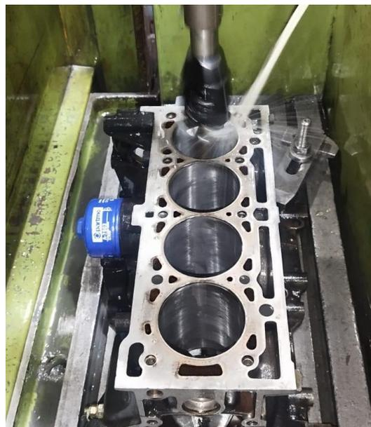
En la figura 17 se puede observar el bruñido de los cilindros, que permite dejar el diámetro interno del cilindro en 80 mm de manera uniforme, sin conicidad ni ovalamiento.
