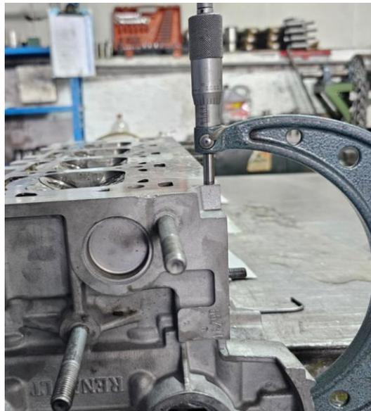
El micrómetro comparador montado en la máquina como se observa en la Figura 22 proporciona la medida precisa del material que se está cepillando en el cabezote. En este caso, según los cálculos previos, el cabezote tiene una medida estándar de 137 mm, por lo que se cepillarán 0.51 mm para alcanzar la relación de compresión deseada.
