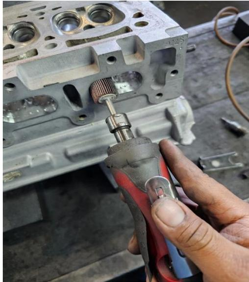
El pulido, por otro lado, se enfoca en alisar las superficies internas de estos conductos para reducir la fricción y la turbulencia. Para ello, se utiliza una serie de piedras de desbaste y abrasivos finos para lograr un acabado suave y uniforme. Estos procesos combinados mejoran el ingreso del aire al motor, aumentando la eficiencia volumétrica y, como resultado, la potencia y el rendimiento general del motor en condiciones de competición.
