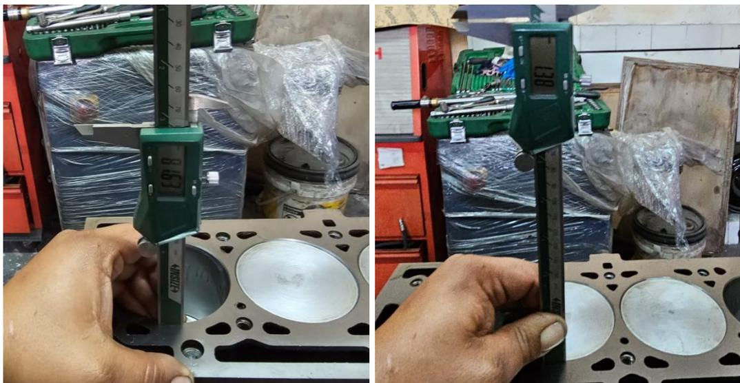
En la figura 19, se aprecia la carrera del cilindro, considerando que el pistón se encuentra en el punto muerto inferior (PMI). Y la carrera del pistón en la posición de punto
