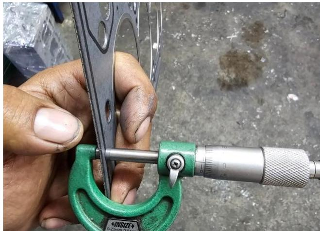
En la figura 12 se observa la medida del empaque original que es de 1.5 mm, este al momento de comprimirse por el torque y debido al material de amianto se reduce a 1.3 mm.
