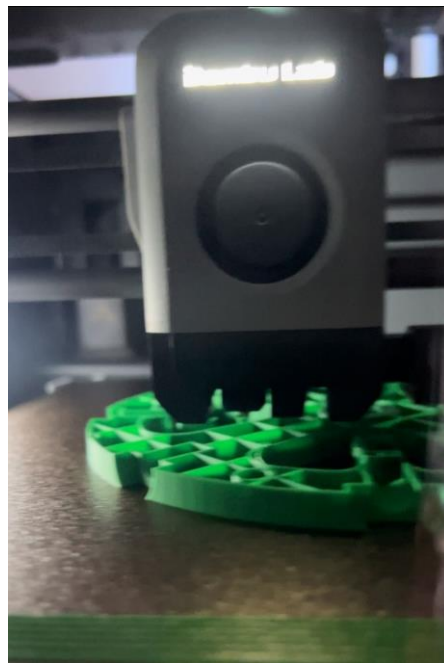
Figura 22. Proceso de impresión con impresora Bambu Lab X1-Carbon
