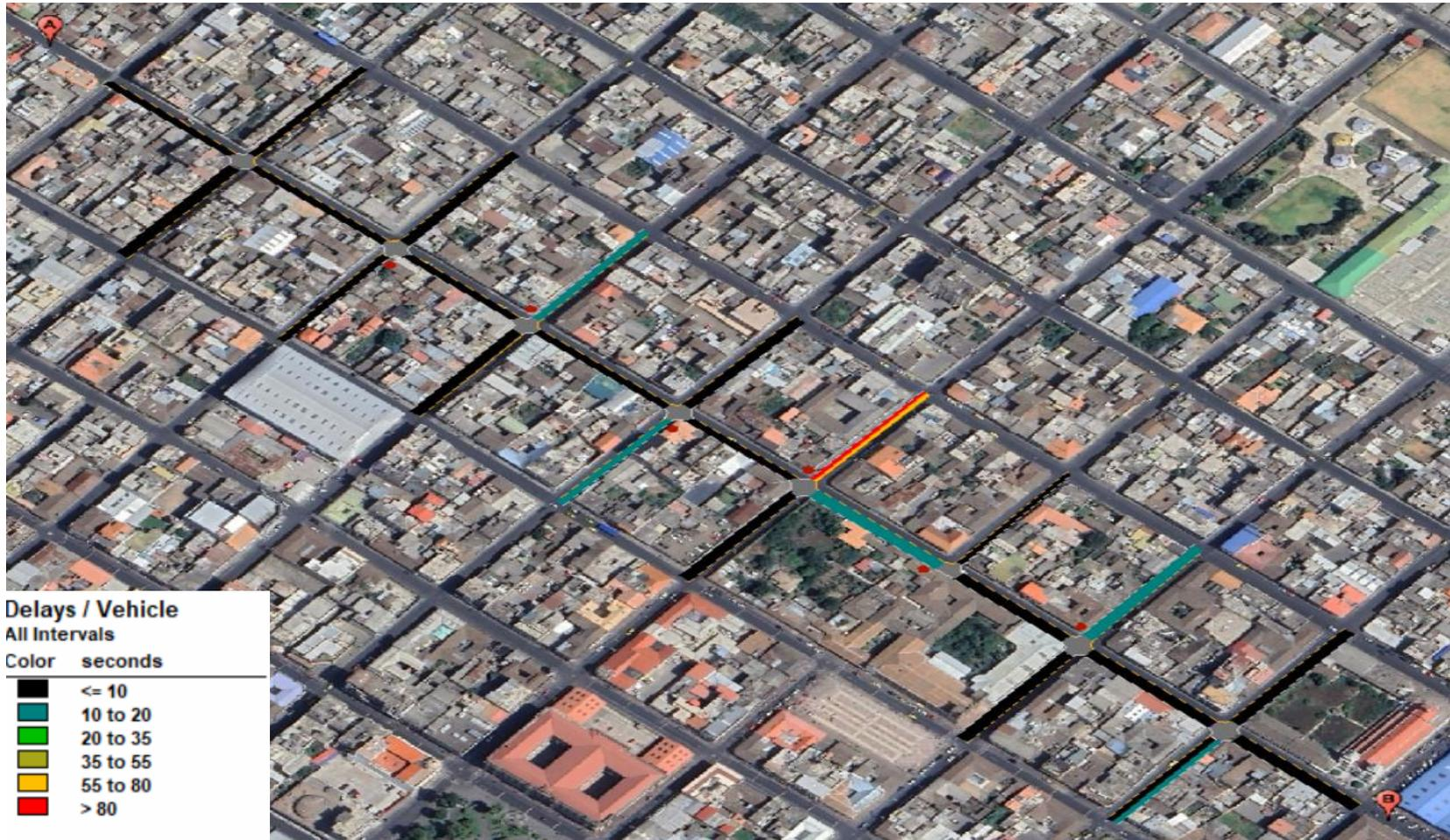
**Ilustración 8:** Modelación tercer escenario de 6:00 a 7:00 de Synchro 11
