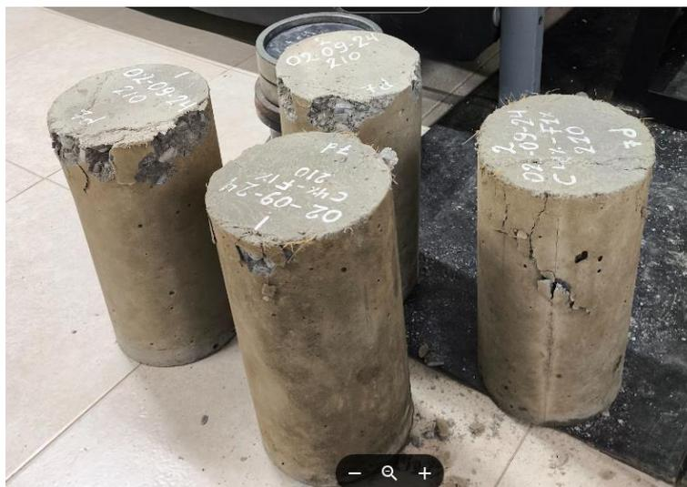
*Figura 15 Probeta mayormente afectada por la compresión*
