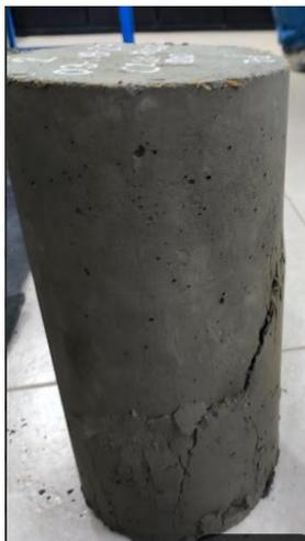
*Figura 13 Probeta mayormente afectada por la compresión*
