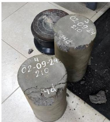
Figura 9 Probetas mayormente afectadas por la compresión
