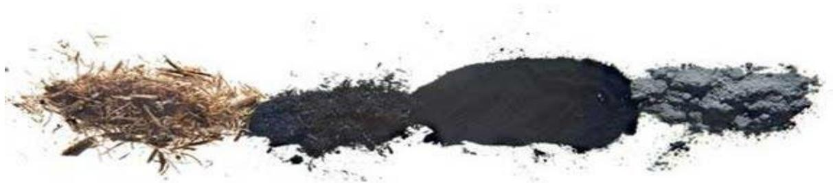
*Figura 1 Cenizas de bagazo de caña de azúcar*
