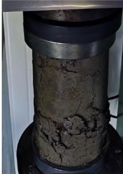
*Figura 11 Probeta mayormente afectada por la compresión*
