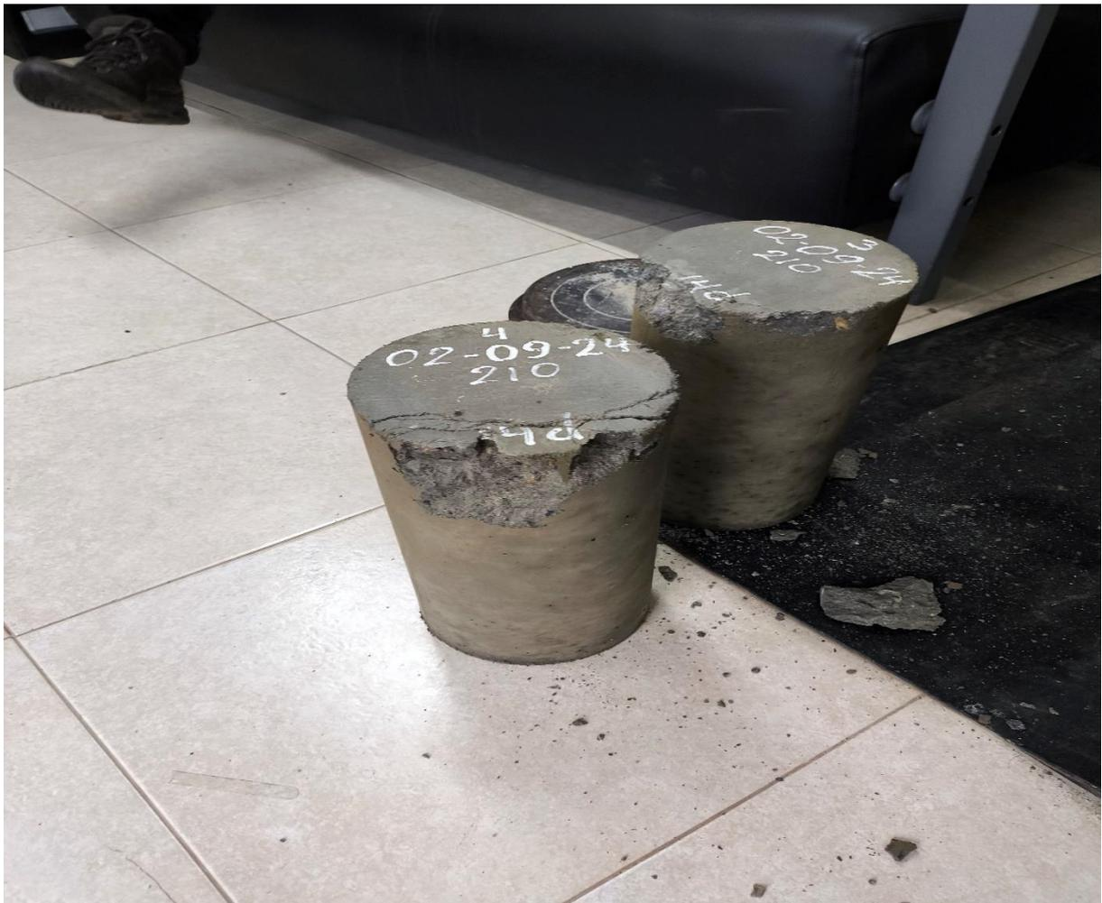
*Anexo 3. Tipos de fallas presentes al realizarse los ensayos de compresión*
