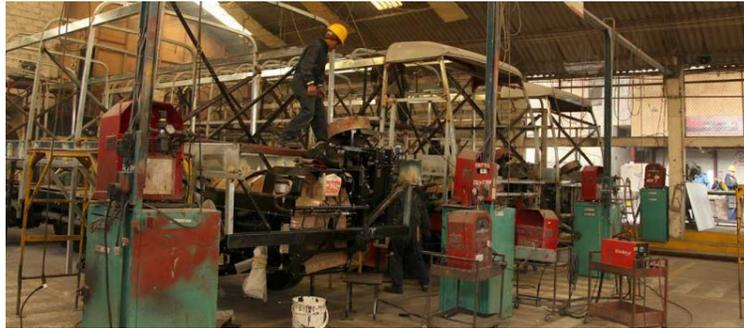
*Nota:* Fabricación de carrocerías para buses y transporte pesado, tomado de: Alcívar, A. (2022,).
