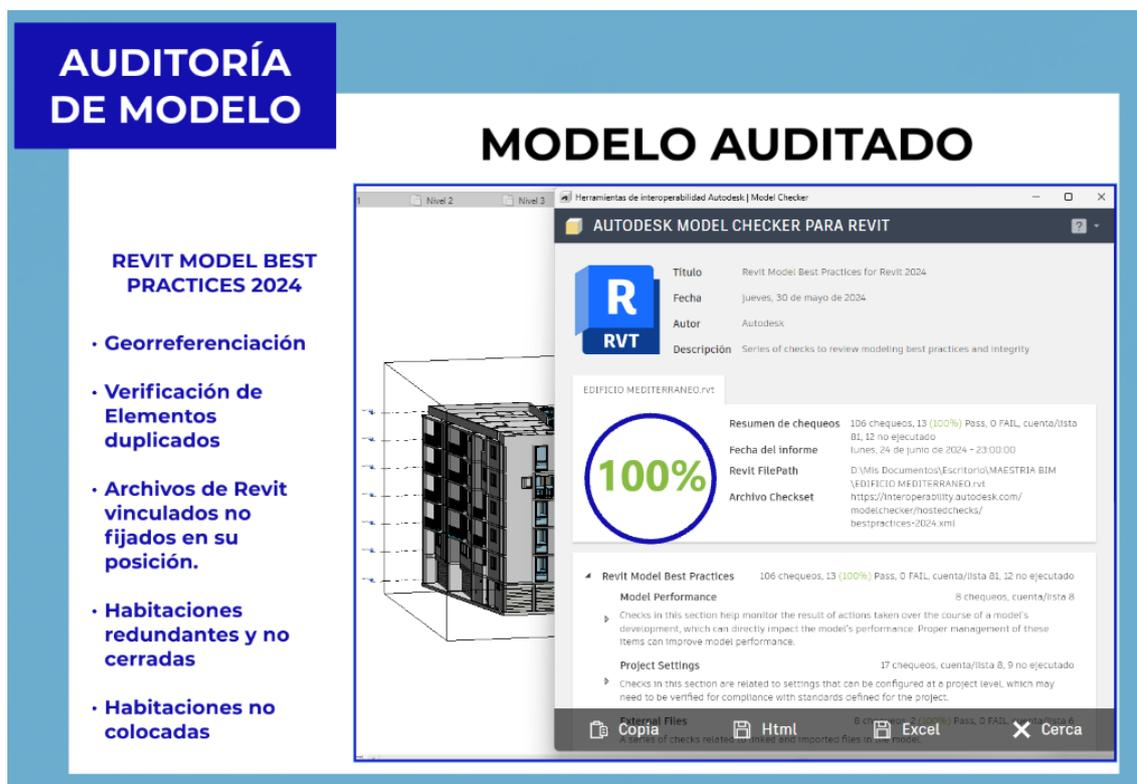
Para llevar a cabo la auditoría del modelo, utilizamos Autodesk Model Checker para Revit. Esta herramienta, configurada con las mejores prácticas de Revit 2024, nos permitió realizar una evaluación exhaustiva del modelo. Entre los aspectos evaluados se encuentran la correcta georreferenciación, la detección de elementos duplicados, habitaciones redundantes o no cerradas, y la verificación de la colocación de las habitaciones. Este modelo inicial servirá como base para que las demás disciplinas
